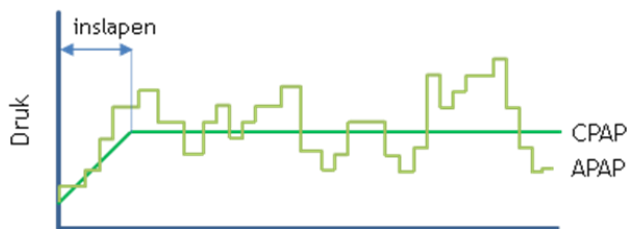
Afb. 8: Voorbeeld van de werking CPAP en APAP apparaat.
