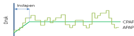
Afbeelding 8: Voorbeeld van de werking CPAP en APAP apparaat.
